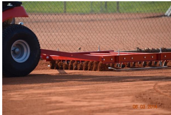
Afbeelding: baaneg met diepte-instelling
