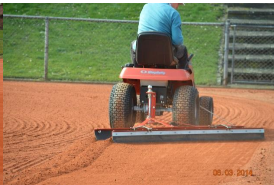
Afbeelding: rubberrei dubbel getrokken
