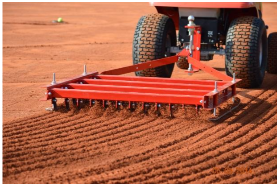
Afbeelding: baaneg met diepte-instelling
