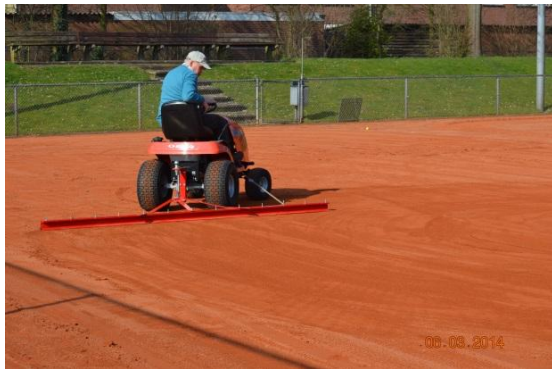
Afbeelding: egalisatiebalk drie meter breed
