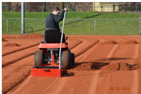
Afbeelding: verzamelbak met gravel op hoopjes
