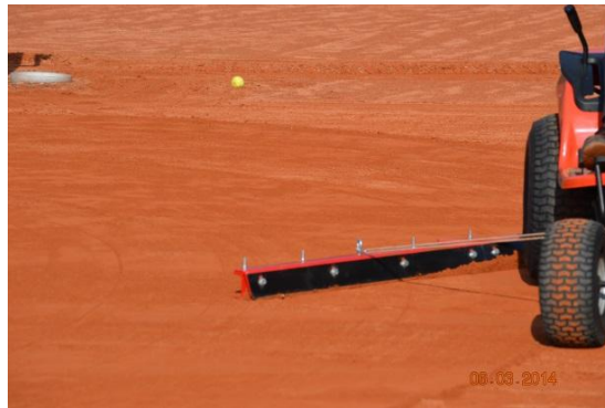
Afbeelding: egalisatiebalk drie meter breed
