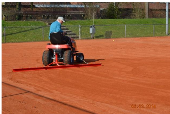
Afbeelding: egalisatiebalk drie meter breed
